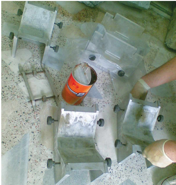
Şekil 6. Süreksizlik içeren örnekler (a) ve süreksizlik makaslama deneyi için kalıp hazırlama (b).
